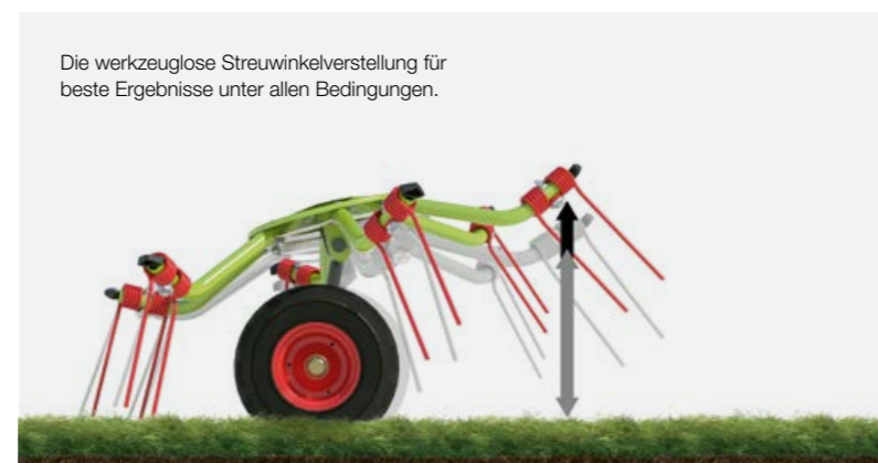
Saubere Rechenarbeit: die Gutaufnahme erfolgt in kleinen Portionen.
